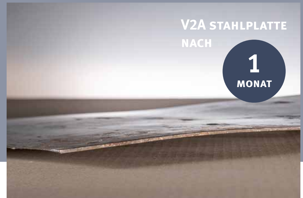
V2A STAHLPLATTE NACH 4 WOCHEN ANWENDUNG (6 STUNDEN TÄGLICH, 5-TAGE-WOCHEN). ARBEITSZEIT FÜR DEN WECHSEL DER PLATTE : 1,5 STUNDEN
