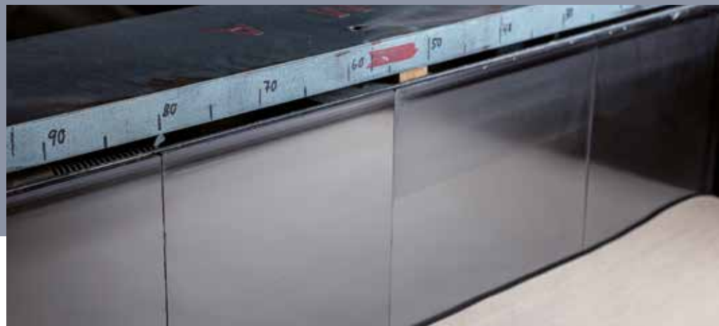
DETAILAUFNAHMEN DER KERAMIKPLATTEN AUF EINER BANDSCHLEIFMASCHINE
