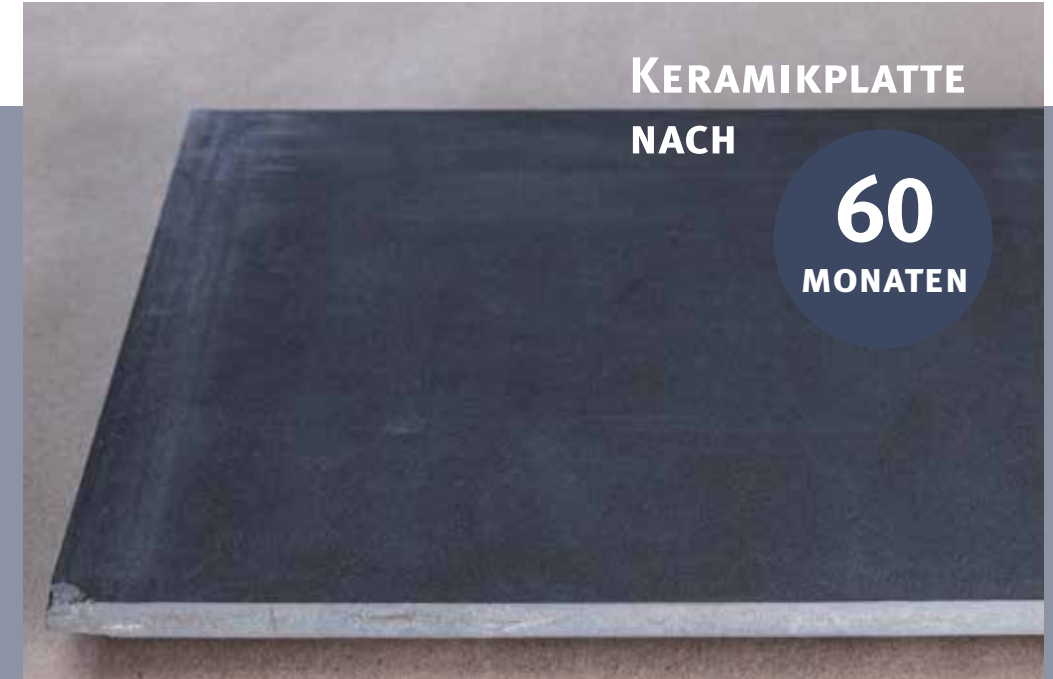
FOTO EINER GEBRAUCHTEN KERAMIKPLATTE NACH CA. 5 JAHREN IN DER ANWENDUNG.
